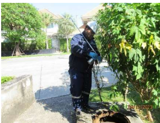
รูปที่ 3-4 ภาพถ่ายการเก็บตัวอย่างน้ำในบ่อเก็บน้ำรดน้ำต้นไม้ หลังผ่านการฆ่าเชื้อโรคด้วยระบบโอโซน
